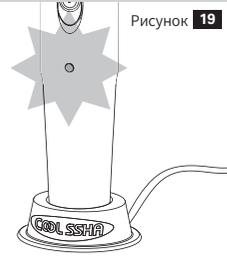
※**Справка:** Он занимает около 8 часов для аккумулятора для полной зарядки.
